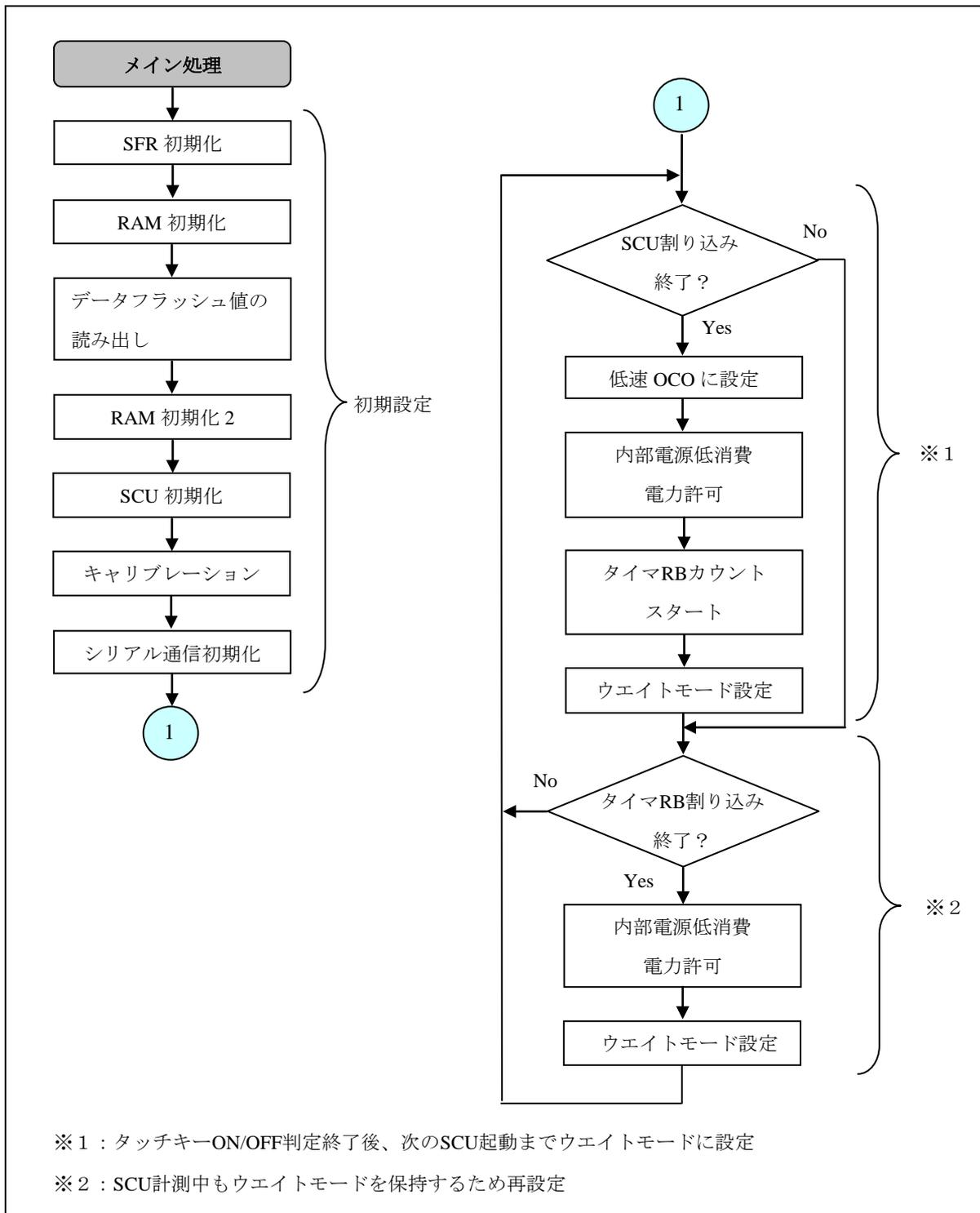
図 2-3 メイン処理の概略フロー
