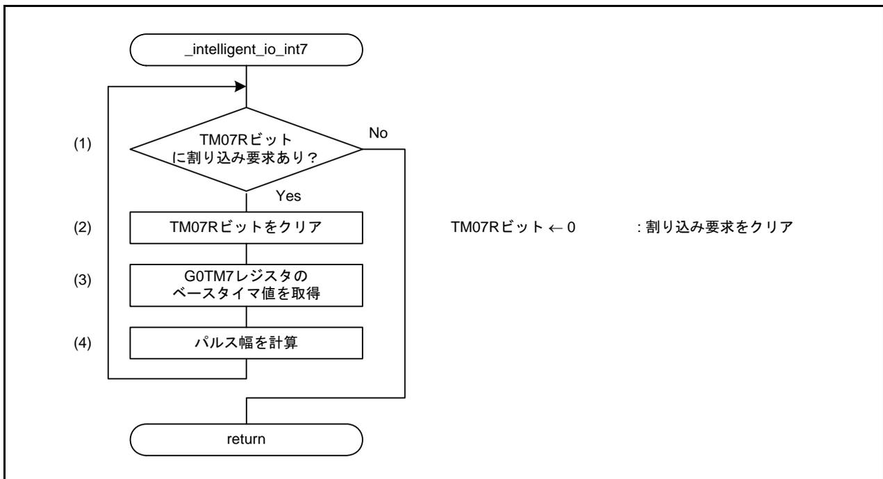
図 5.4 インテリジェントI/O 割り込み7処理
