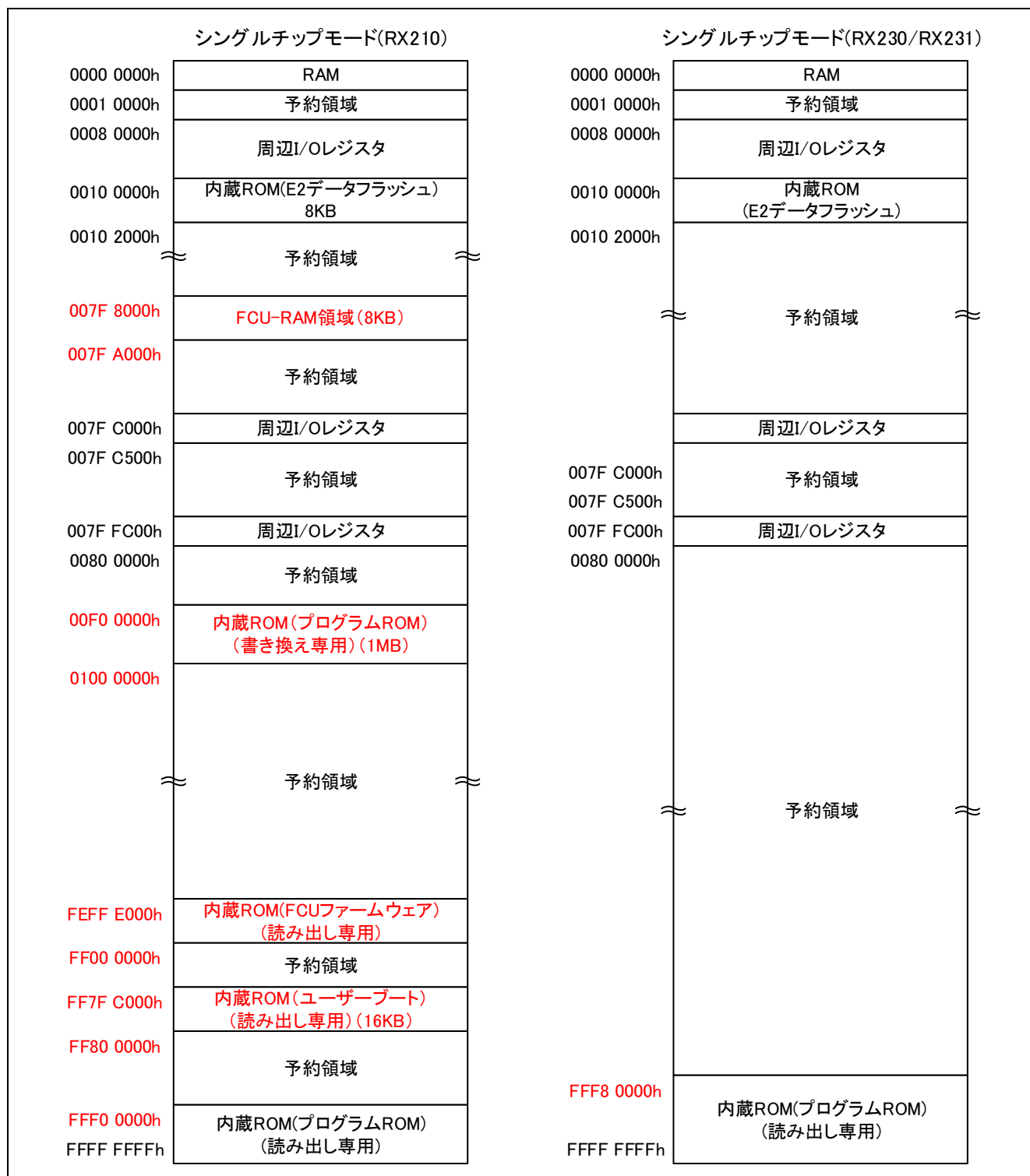
図 4.1 メモリマップ比較 (シングルチップモード)
