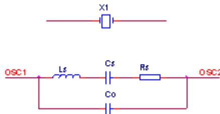
**Figure 1.1**      **Equivalent Circuit**
