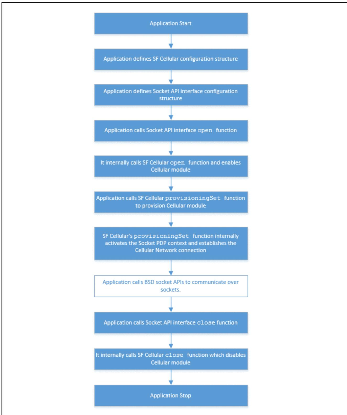
図3 セルラーフレームワークモジュールのソケットインタフェース
