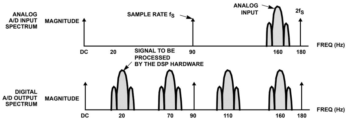
FIGURE 2B. UNDERSAMPLED 120MHz IF INPUT SPECTRAL PLOTS
