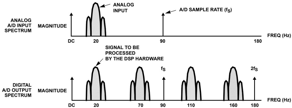
FIGURE 2A. OVERSAMPLED 20MHz IF INPUT SPECTRAL PLOTS
