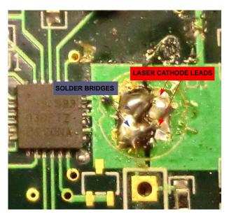
FIGURE 3. DUAL CATHODE LASER ATTACHED
