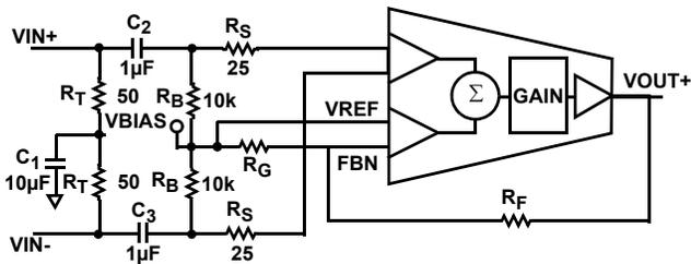
FIGURE 9. CAT-5 CABLE TERMINATION SCHEME
