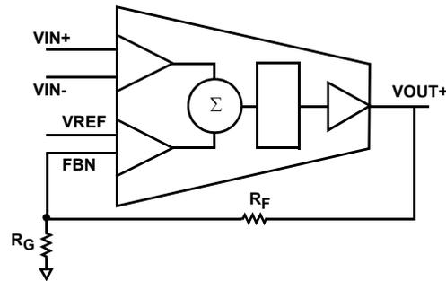
FIGURE 7. EL5175 DIFFERENTIAL TO SINGLE-ENDED AMPLIFIER BLOCK DIAGRAM
