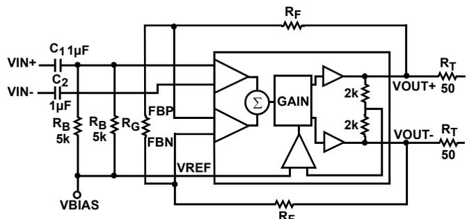
FIGURE 8. CAT-5 CABLE TERMINATION SCHEME (DRIVER SIDE)
