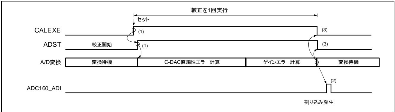
図 9 キャリブレーション動作例 (C-DAC 直線性誤差の計算とゲイン誤差の計算)
