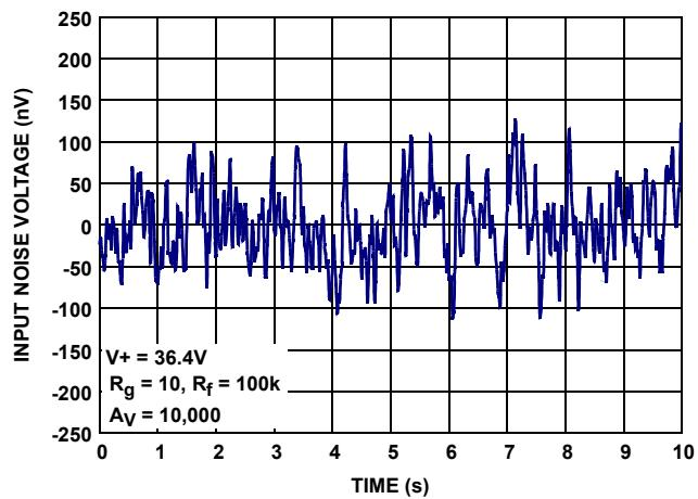
FIGURE 23. INPUT NOISE VOLTAGE 0.1Hz TO 10Hz
