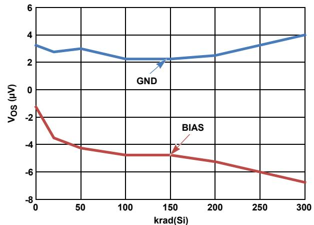
FIGURE 44. V<sub>OS</sub> vs HIGH DOSE RATE RADIATION
