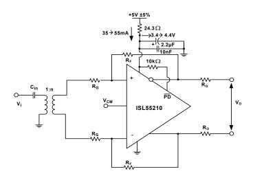
FIGURE 32. OPERATING FROM A SINGLE +5V SUPPLY
