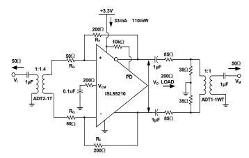
FIGURE 28. TEST CIRCUIT #1
