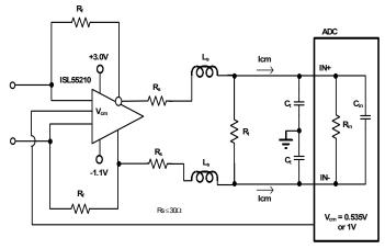
FIGURE 37. DC COUPLED WITH A COMMON V<sub>CM</sub> VOLTAGE FROM THE
