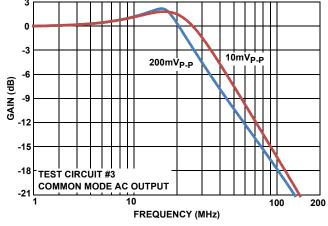
FIGURE 18. V<sub>CM</sub> PIN INPUT FREQUENCY RESPONSE TO OUTPUT COMMON MODE
