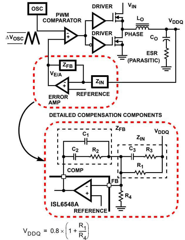
$$V_{DDQ} = 0.8 \times \left( 1 + \frac{R_1}{R_4} \right)$$
