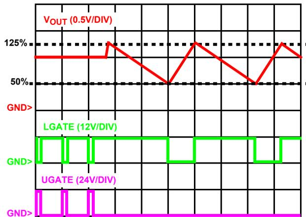
FIGURE 8. OVERVOLTAGE PROTECTION
