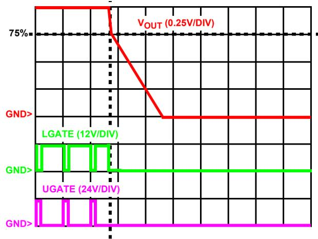
FIGURE 7. UNDERVOLTAGE PROTECTION
