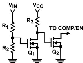
FIGURE 10. SEQUENCER CIRCUIT
