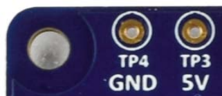
図6 ターゲットボード上のテストポイント TP3 および TP4
