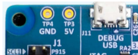
図4 TB-S3A3のUSBデバッグコネクタ（J11）、TP3、およびTP4
