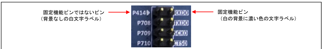
図20 固定機能用ピンのラベルの例
