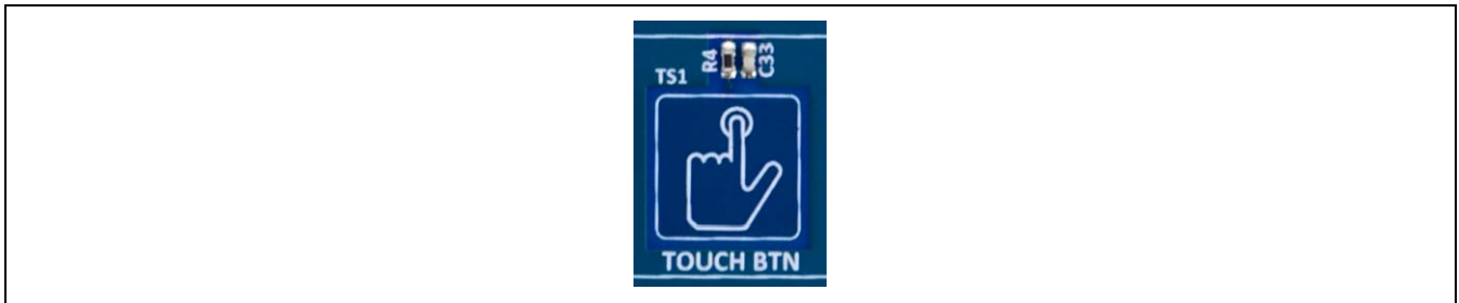
図19 ターゲットボード上の静電容量式タッチボタン（上面）
