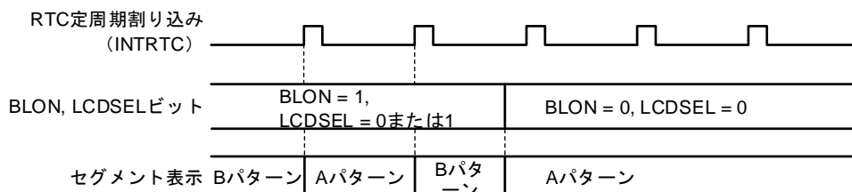
図16-16 点滅表示からAパターン表示への切り替え動作
