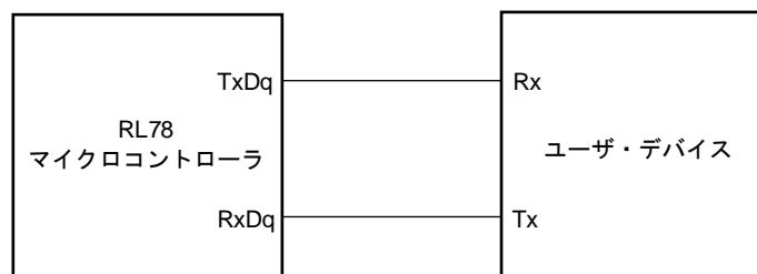
UARTモード接続図 (同電位通信時)
