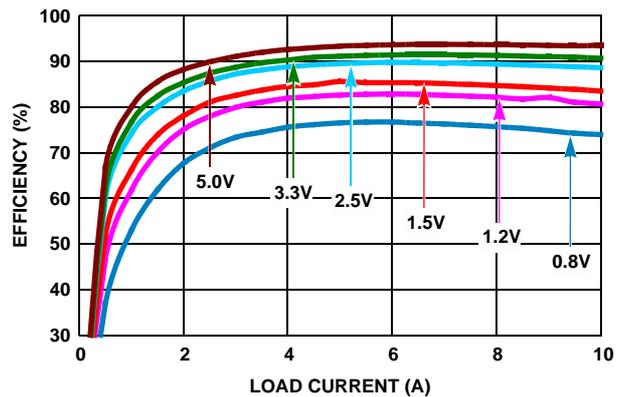
図 3. 効率 vs 負荷電流 ( $12V_{IN}$ )
