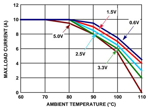
図 25. ディレーティング曲線 (12V<sub>IN</sub>)
