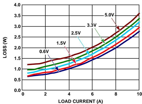
図 24. 電力損失 vs 負荷電流 (12V<sub>IN</sub>)
