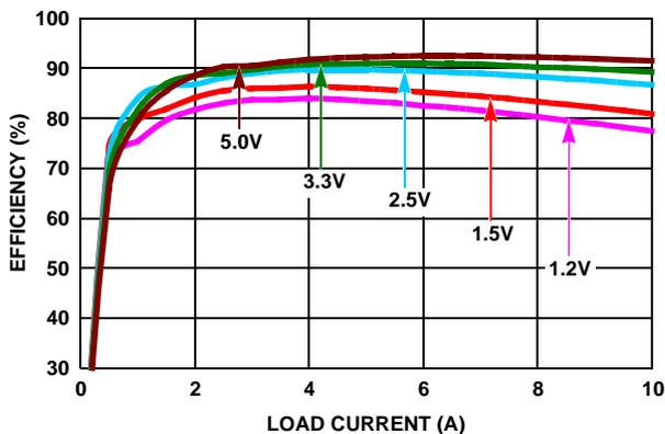
図 4. 効率 vs 負荷電流 ( $18V_{IN}$ )
