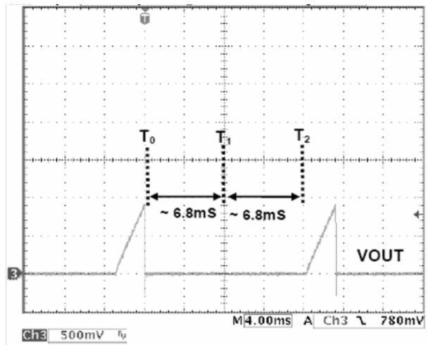
図 19. 過電流リトライ動作
