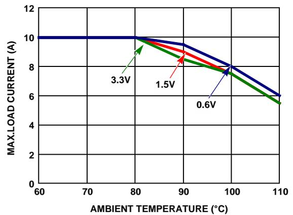
図 23. ディレーティング曲線 (5V<sub>IN</sub>)
