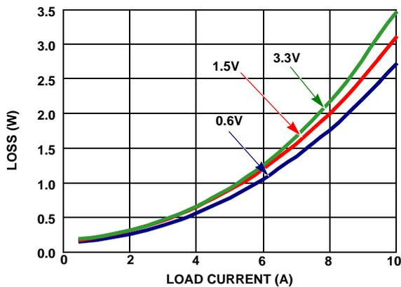
図 22. 電力損失 vs 負荷電流 (5V<sub>IN</sub>)
