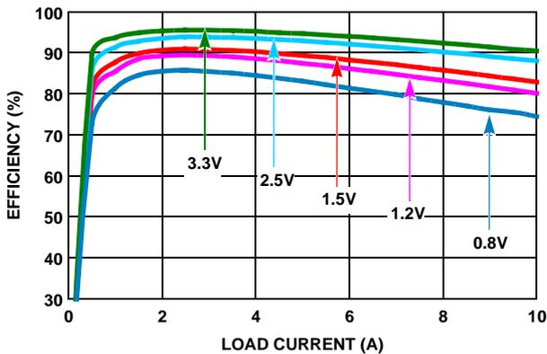
図 2. 効率 vs 負荷電流 ( $5V_{IN}$ )
