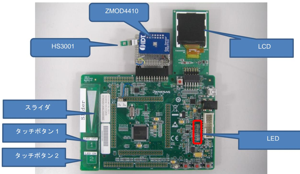
Figure 2.1 RSK とセンサの接続例
