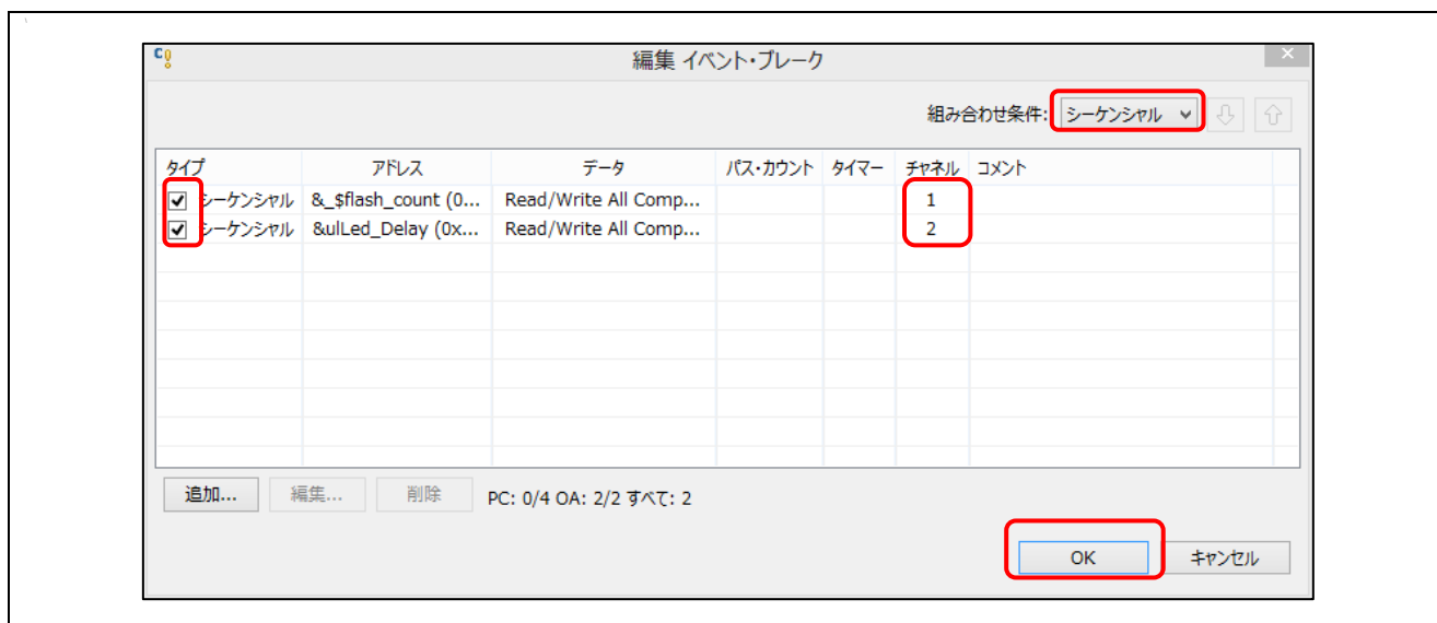
図7 [イベント・ブレークの編集] ダイアログ — “シーケンシャル” イベント
