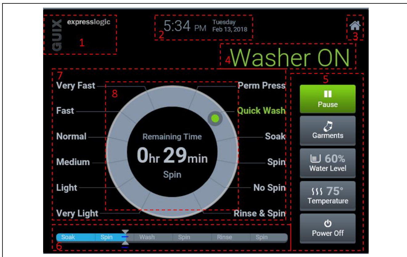
図 3 洗濯機コントローラで使用する GUI の概要
