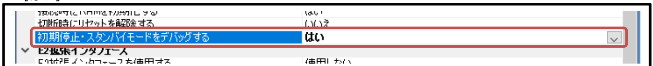
図 4 CS+での CPU コアの起動手順・スタンバイモードデバッグ設定
