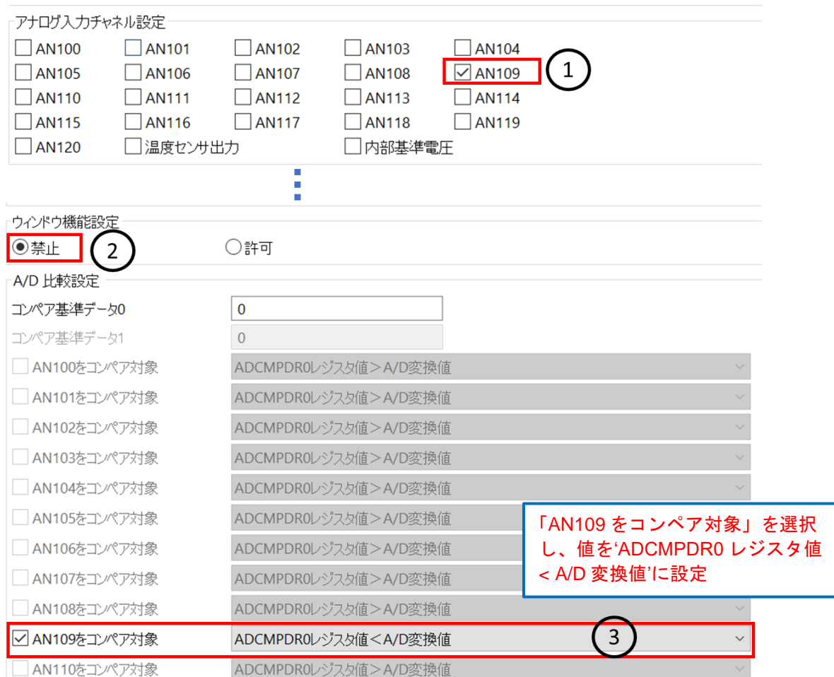
図 3.1 コンペアレベルを「ADCMPDR0 レジスタ値 < A/D 変換値」に設定する GUI 画面
