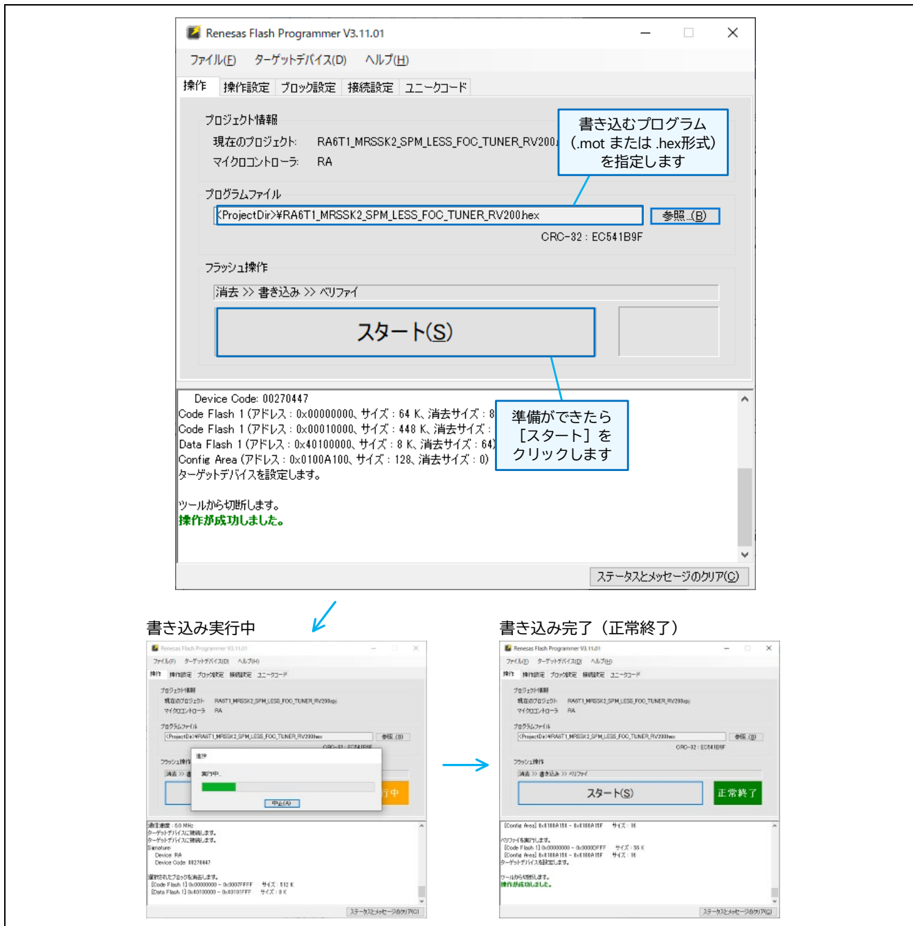
図 2-17 Renesas Flash Programmer による実行プログラムの書き込み (2/2)
