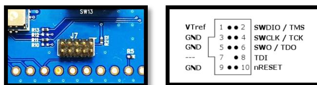
**Figure 59: JTAG Pin Connection**
