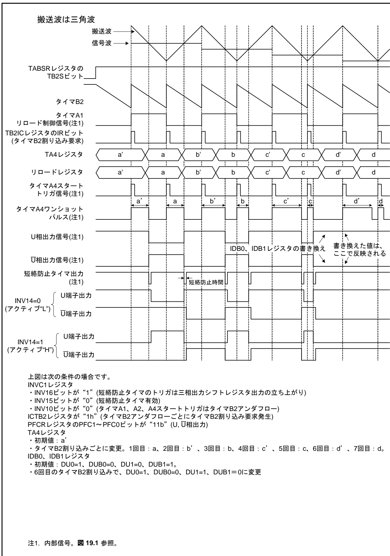
図 19.6 三相モード0の動作例
