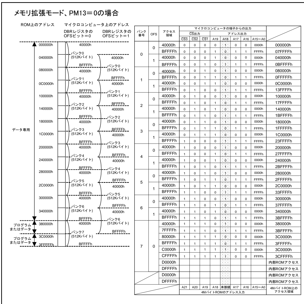
図 12.6 4MバイトROMのアドレスとマイクロコンピュータのアドレスとの関係 (1/3)
