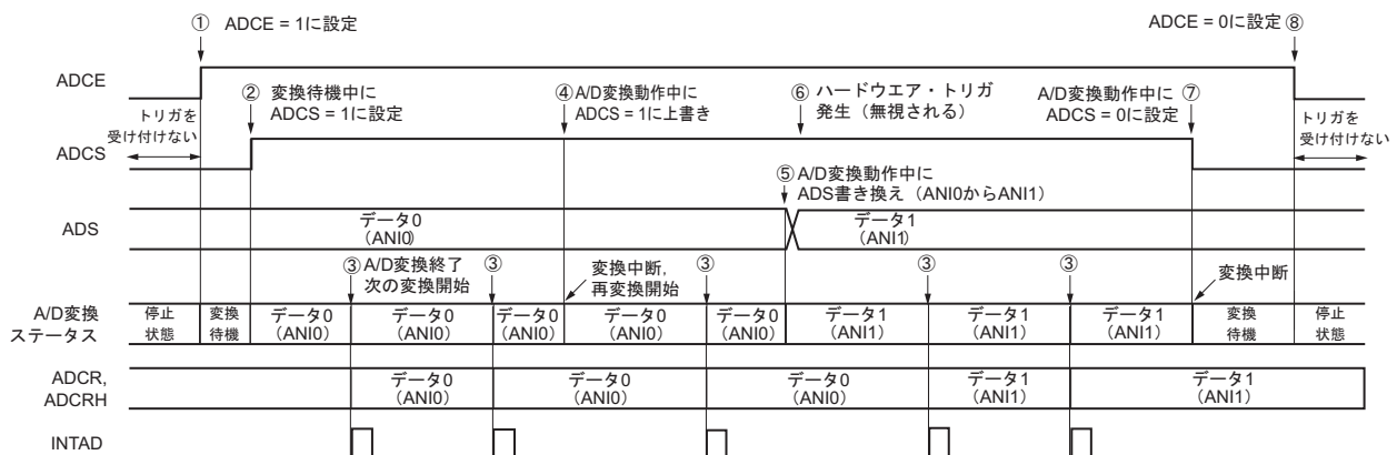
図12-19 ソフトウェア・トリガ・モード(セレクト・モード, 連続変換モード)動作タイミング例
