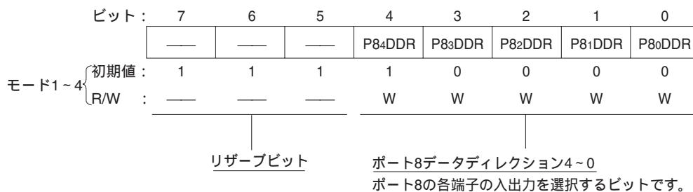
P8<sub>4</sub> ~ P8<sub>1</sub> は P8DDR の対応するビットが 1 のとき  $\overline{CS}_0 \sim \overline{CS}_3$  出力端子となり、0 のとき入力ポートとなります。リセット直後は P8<sub>4</sub>のみ  $\overline{CS}_0$  出力となり、他の 3 端子は入力ポートとなります。
