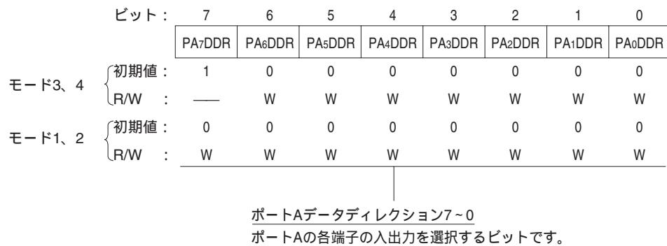
PADDR を 1 にセットすると対応するポート A の各端子は出力となり、0 にクリアすると入力になります。ただし、モード 3、4 では PA<sub>i</sub>DDR は 1 に固定され、PA<sub>i</sub> はアドレス出力として機能します。
