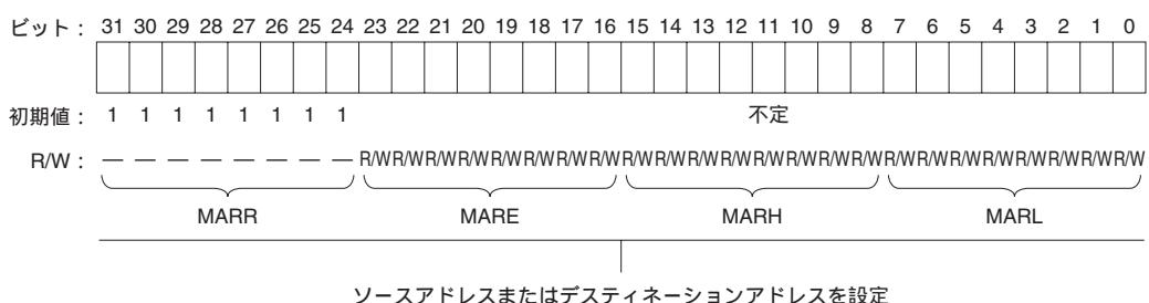
MAR は 1 回のバイト転送またはワード転送のたびにインクリメント / デクリメントされ、ソースまたはデスティネーションのメモリアドレスを自動的に更新することができます。詳細は、「7.3.4 データトランスマスクコントロールレジスタ (DTCR)」を参照してください。
