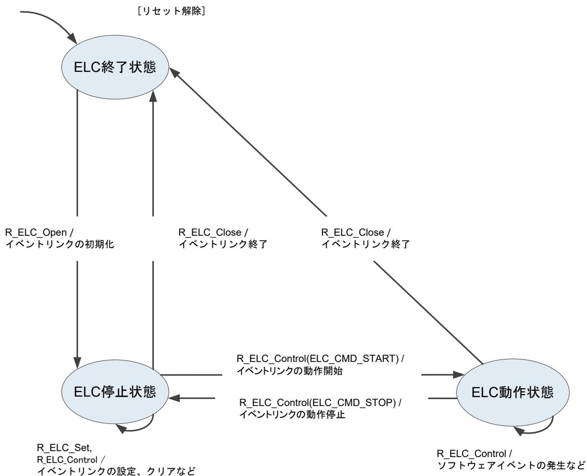
図 1.3 ELC FIT モジュールの状態遷移図
