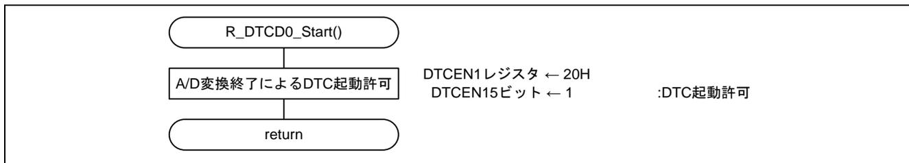
図 7.12 DTC 起動許可設定 (単掃引モードからの移行例)
