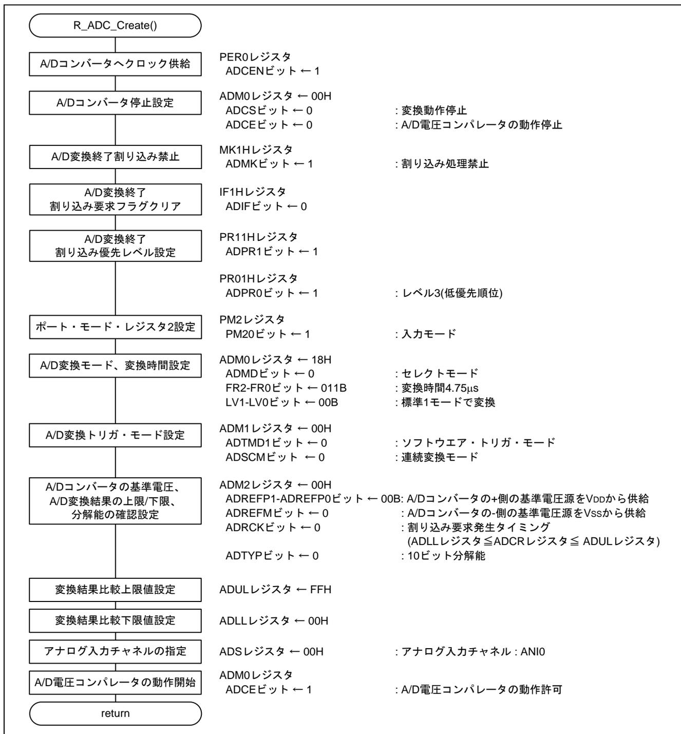
図 5.9 A/D コンバータ初期設定 (繰り返しモード 0 からの移行例)
