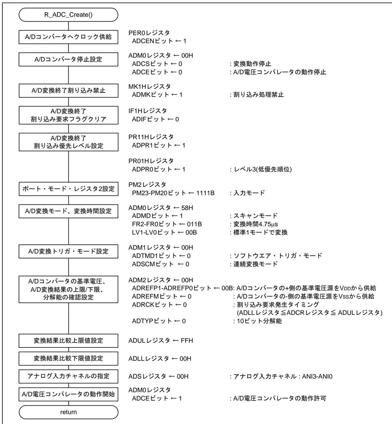
図 8.9 A/D コンバータ初期設定 (繰り返し掃引モードからの移行例)
