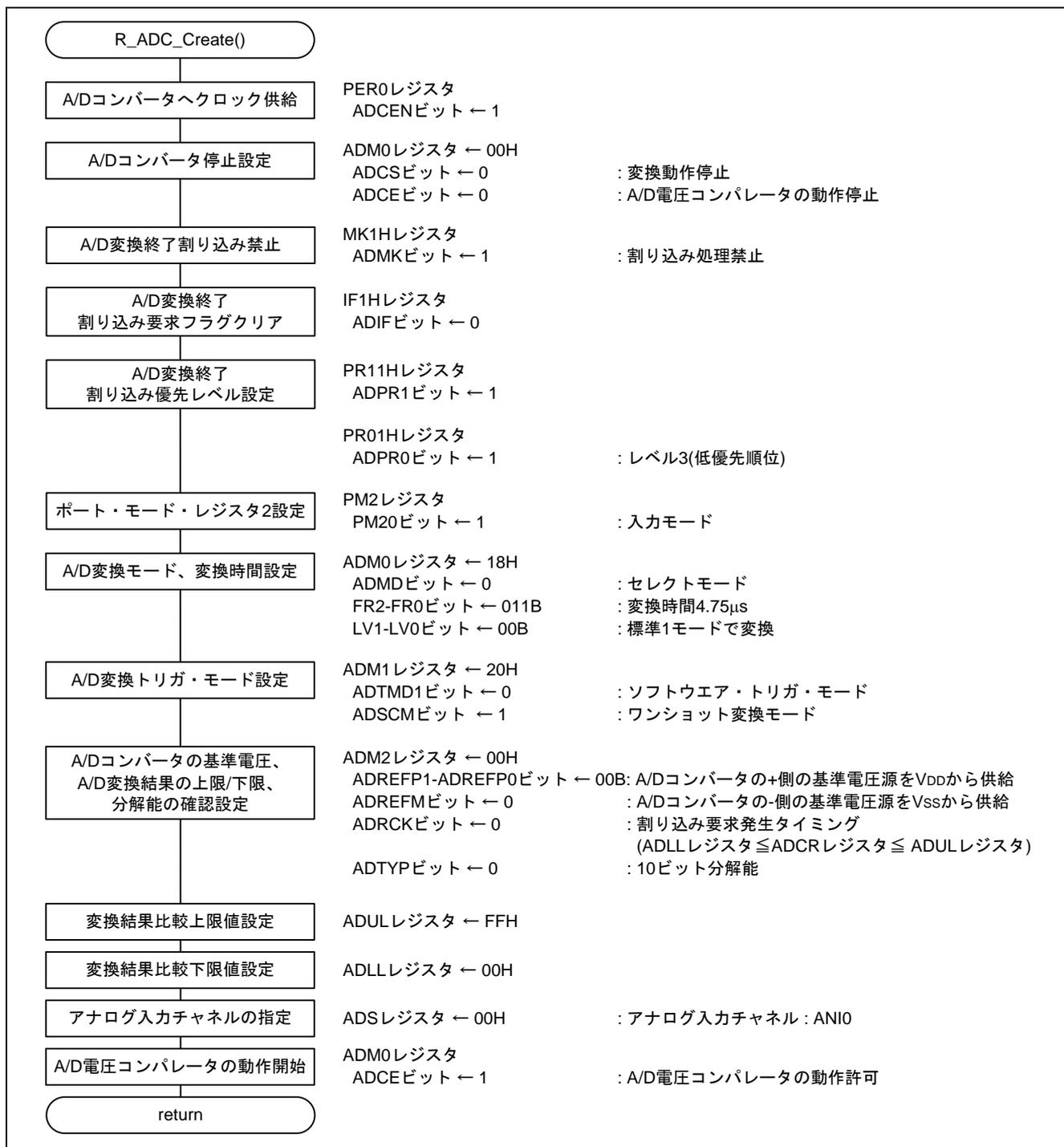
図 4.9 A/D コンバータ初期設定 (単発モードからの移行例)
