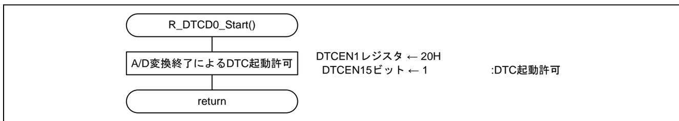
図 6.12 DTC 起動許可設定 (繰り返しモード 1 からの移行例)
