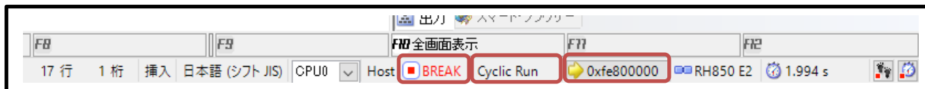
図 4-33 CS+での Cyclic RUN モードでブレーク状態に変化したステータス表示
