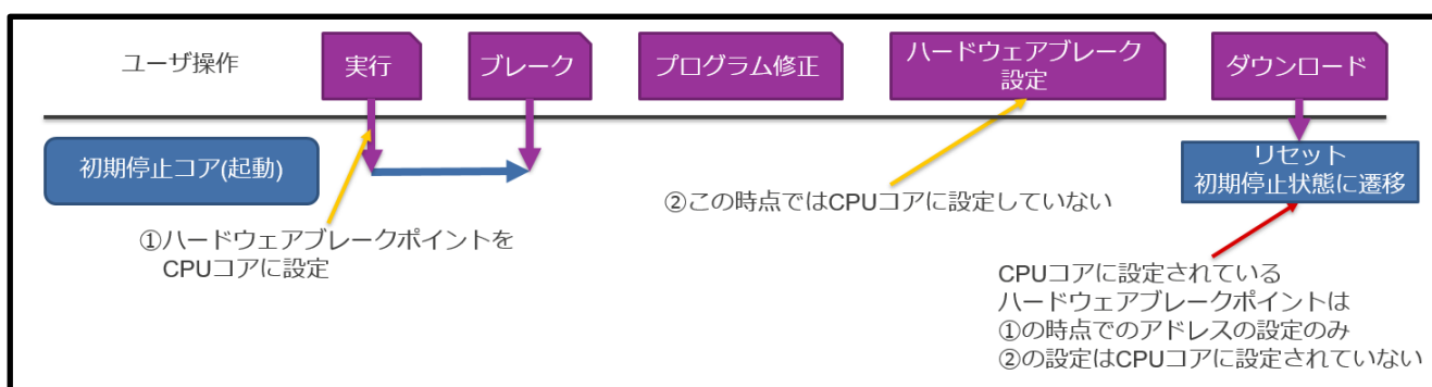
図 5-7 CS+/MULTI でのダウンロード後におけるハードウェアブレイクポイントの設定状態
