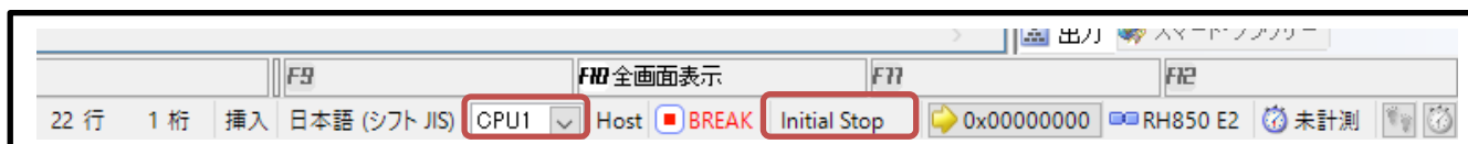
図 4-3 CS+での初期停止コアが初期停止状態であることステータス表示
