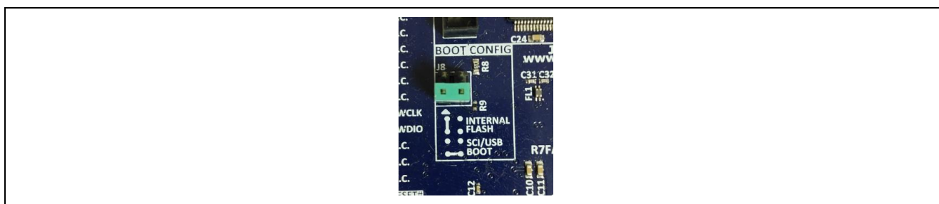
図 2-1 J8 ジャンパを「SCI/USB BOOT」に設定 (FW 書き込み時に設定)
