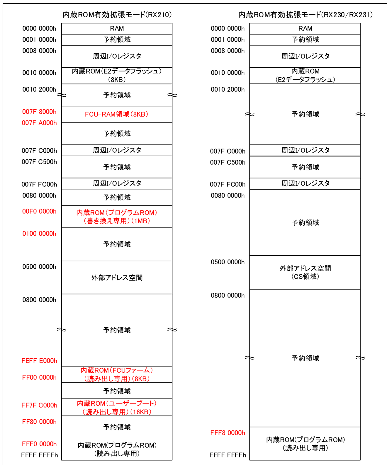
図 4.2 メモリマップ比較 (内蔵 ROM 有効拡張モード)
