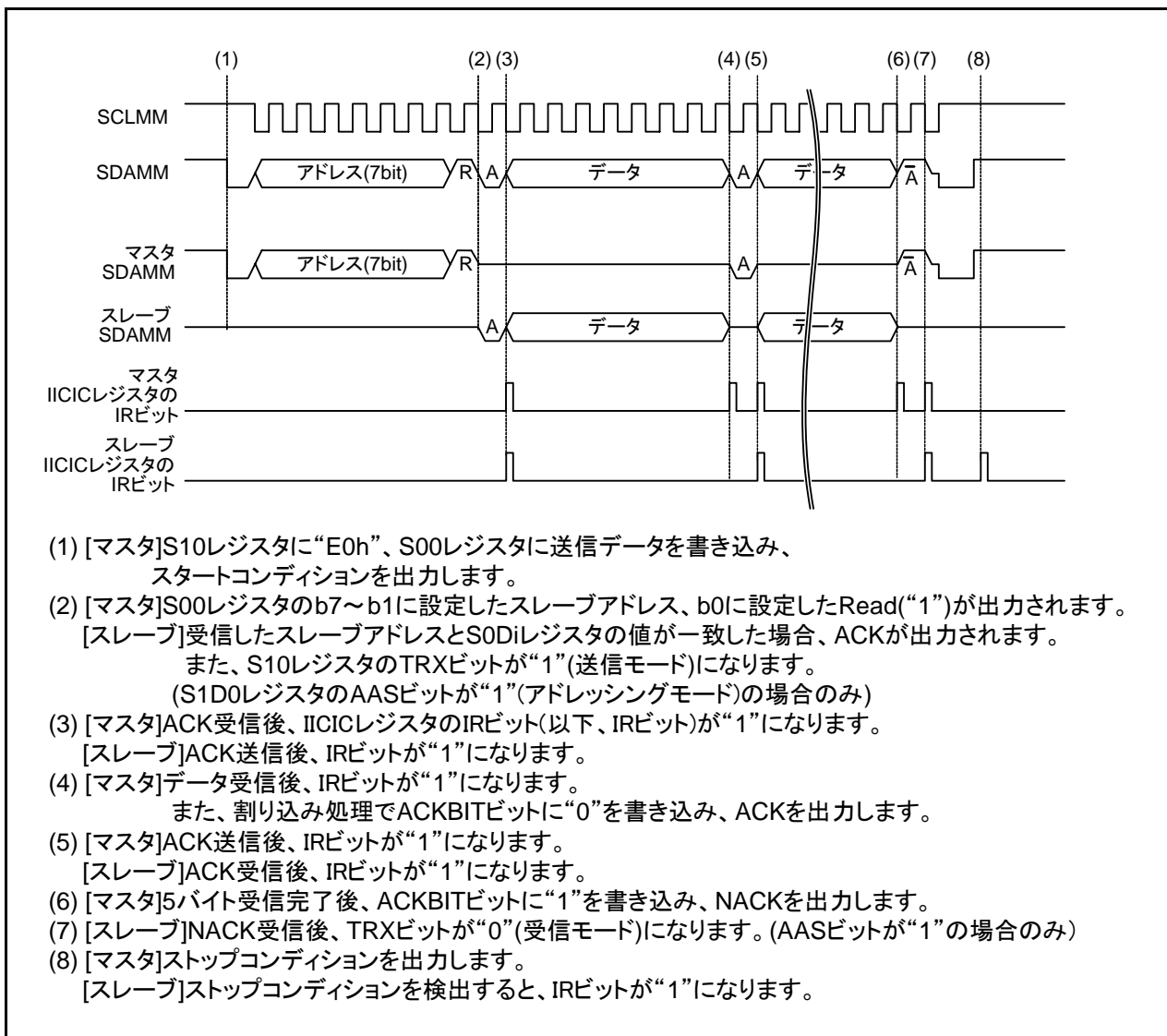
図 8.5 マスタ受信—スレーブ送信の動作例
