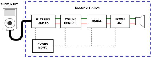
FIGURE 1. AUDIO DOCKING STATION BLOCK DIAGRAM
