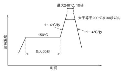
图1 回流时的推荐温度分布图
