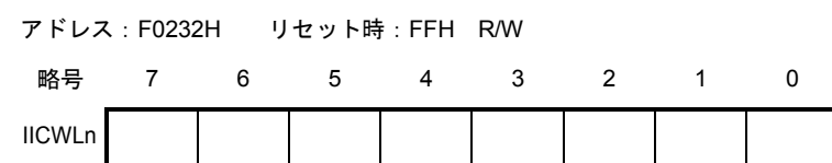
図19-10 IICAロウ・レベル幅設定レジスタn (IICWLn) のフォーマット
