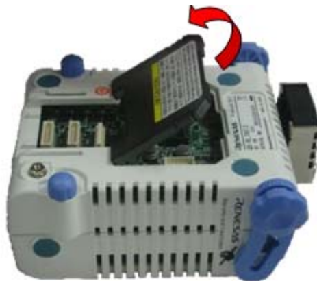
図2-1 亚克力板の取り外し方法
