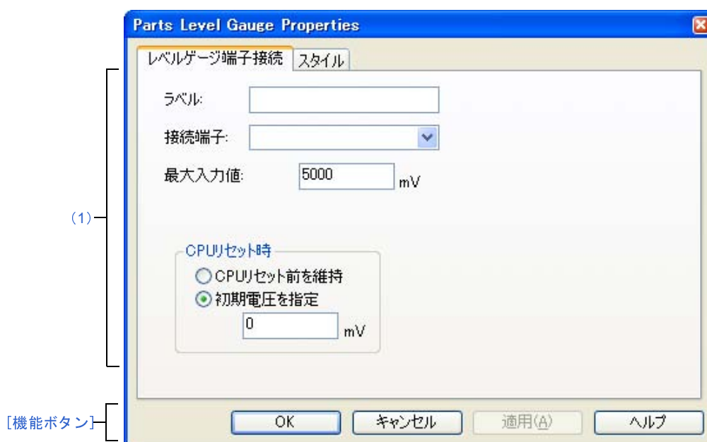
図 A—99 Parts Level Gauge Properties ダイアログ : [レベルゲージ端子接続] タブ
