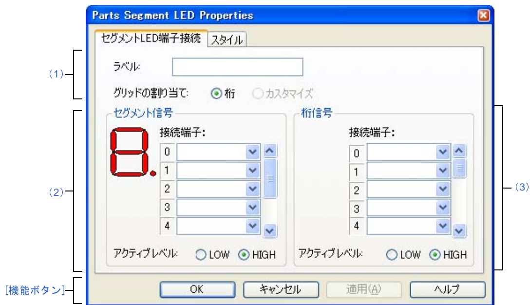
図 A-102 Parts Segment LED Properties ダイアログ : [セグメントLED 端子接続] タブ
