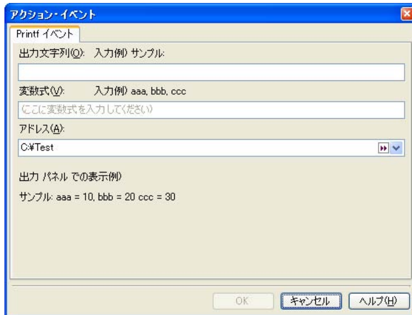
図 2—150 Printf イベントを設定する（アクション・イベント ダイアログ：[Printf イベント] タブ）
