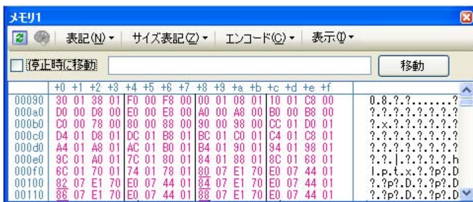
図 2—102 リアルタイム表示更新を行っているメモリ表示の例（メモリパネル）
