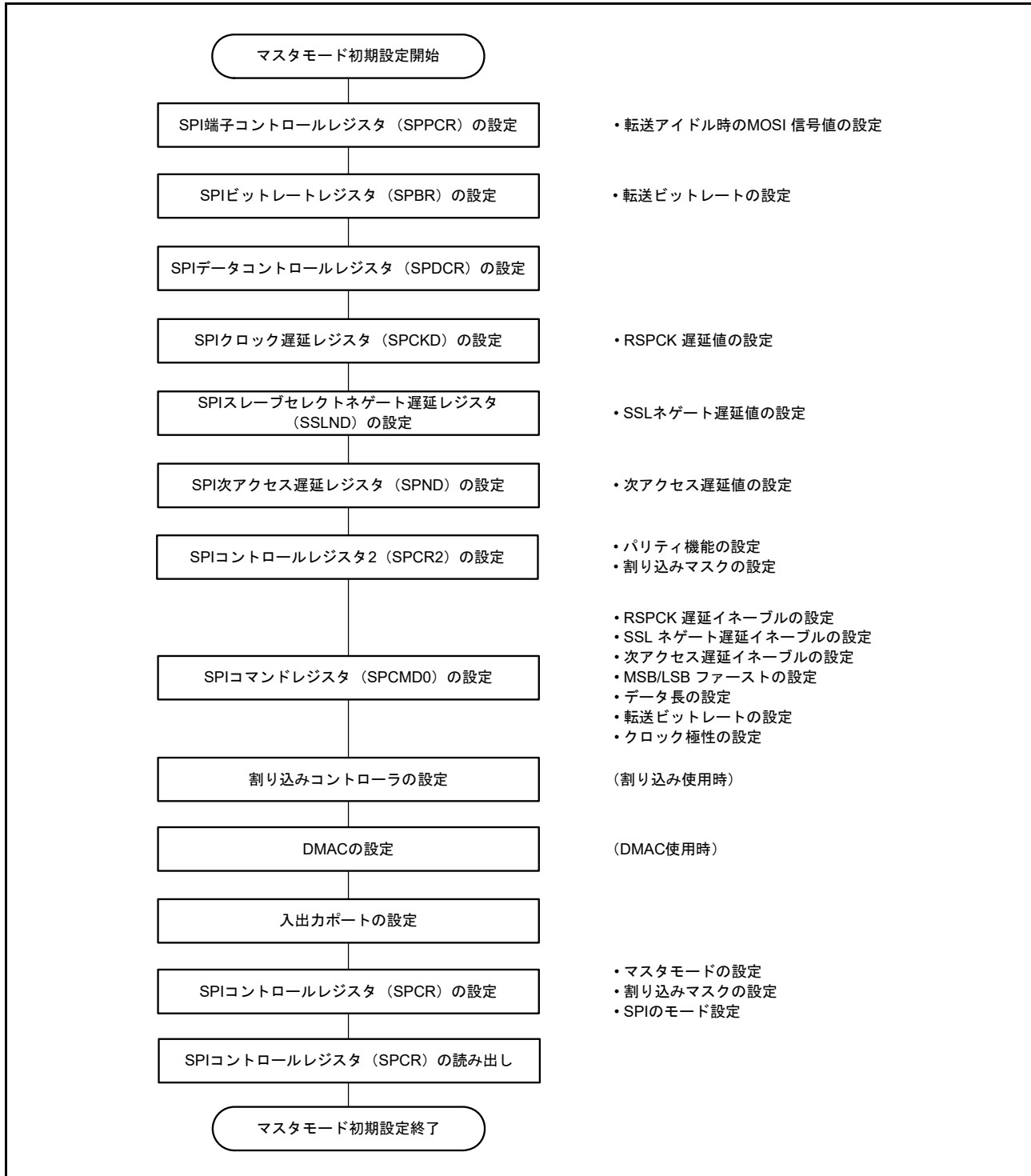
図 31.40 マスターモード時のクロック同期式動作の初期化フロー例
