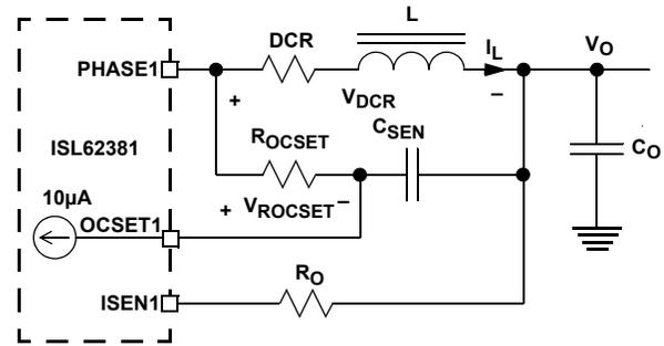
FIGURE 26. OVERCURRENT-SET CIRCUIT
