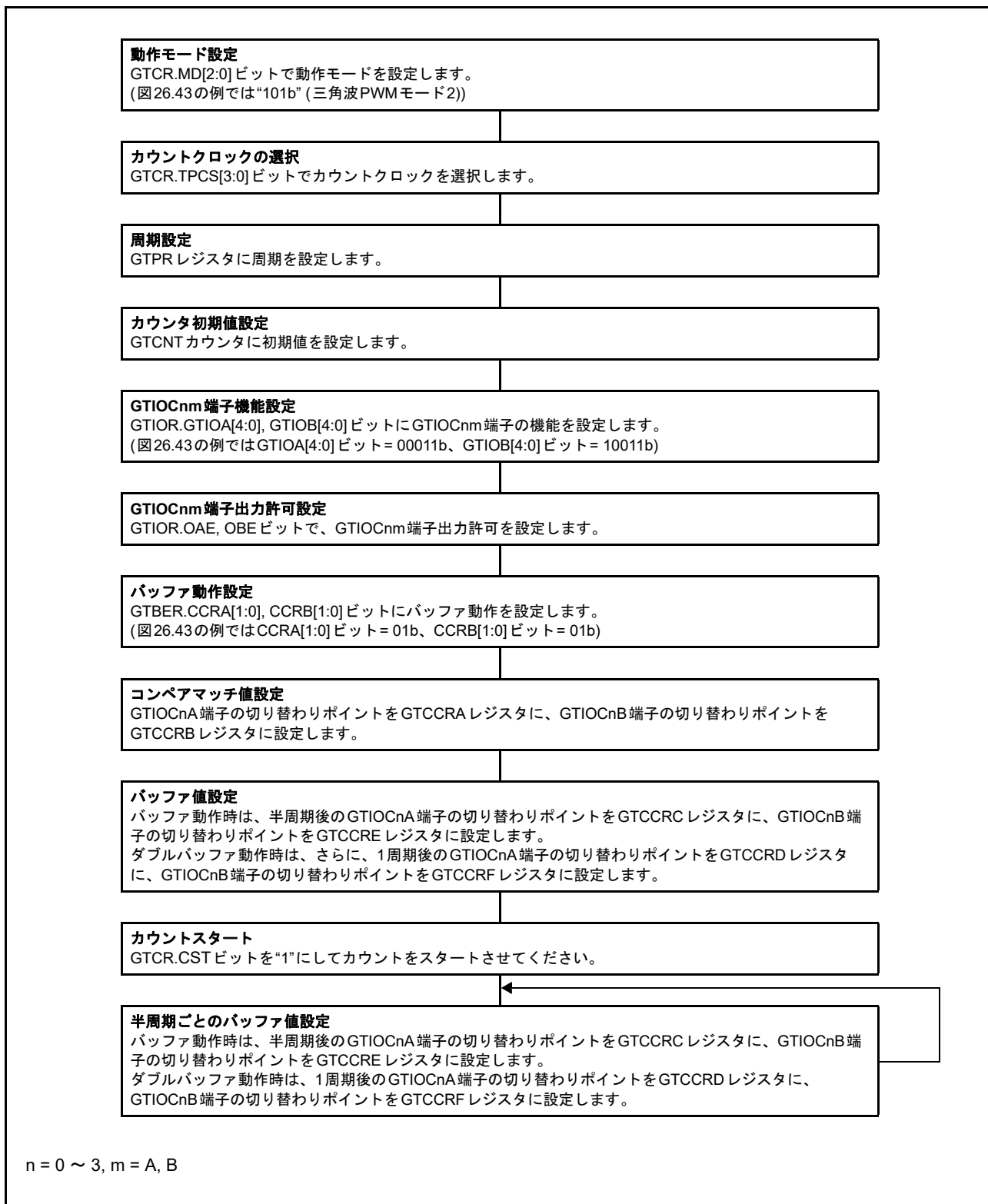
図 26.44 三角波 PWM モード 2 設定例
