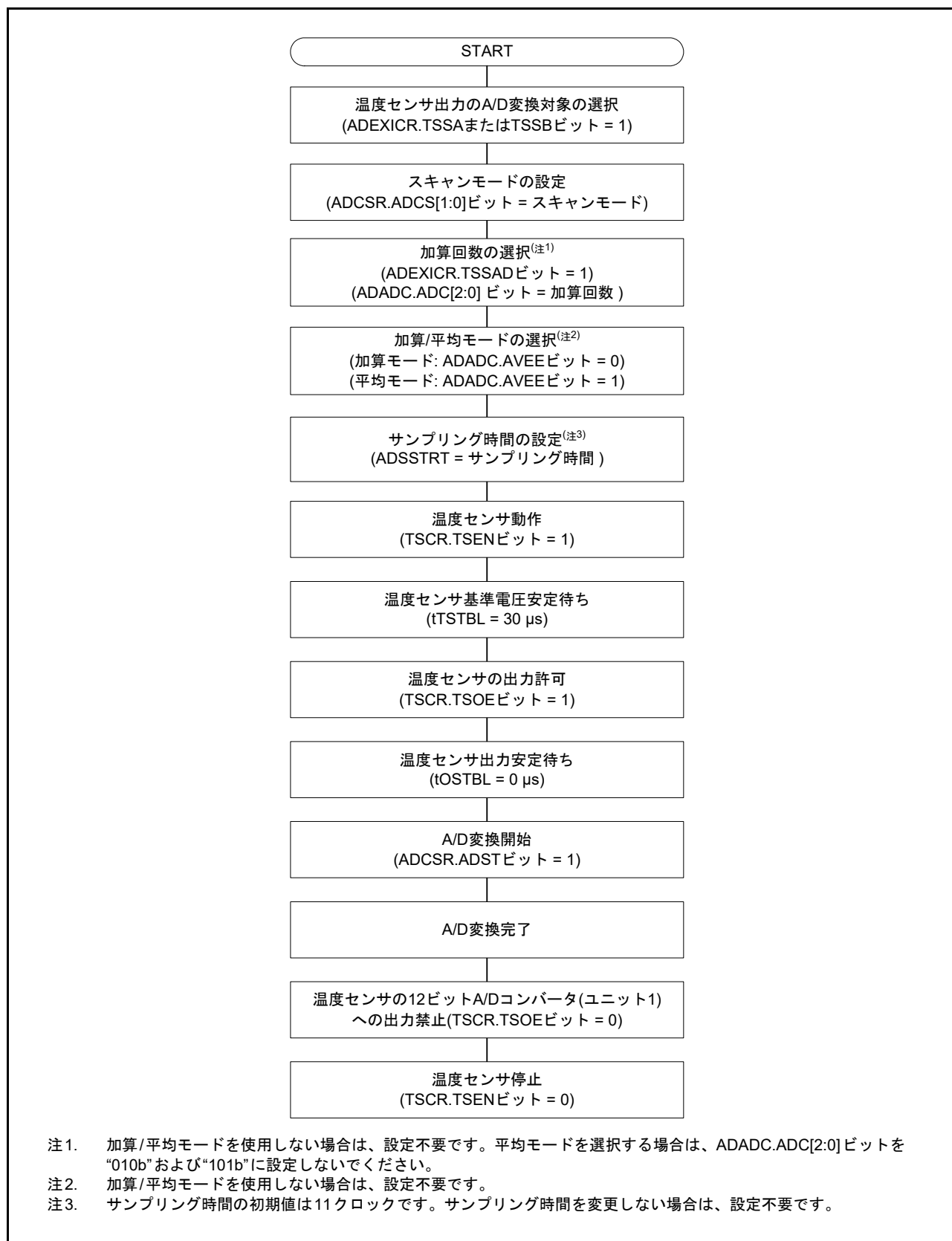
図 60.3 温度センサの使用手順フロー
