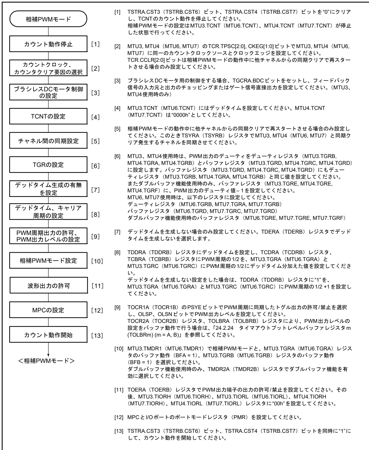
図 24.48 相補 PWM モードの設定手順例
