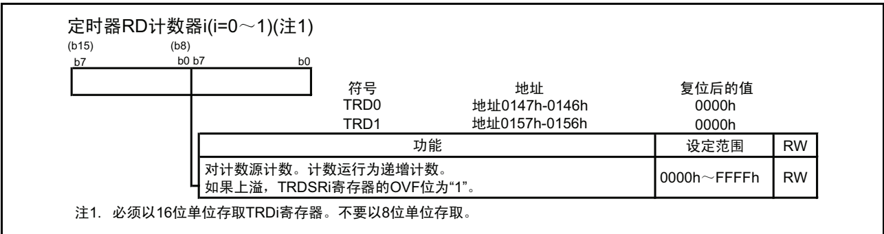
图 15.42 输入捕捉功能时的 TRD0 ~ TRD1 寄存器
