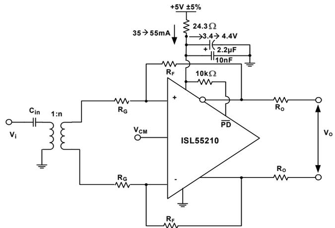
FIGURE 32. OPERATING FROM A SINGLE +5V SUPPLY
