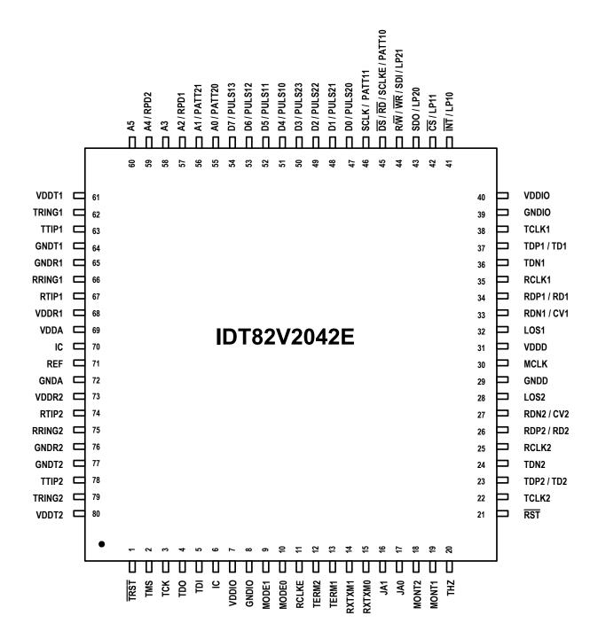
Figure-2 IDT82V2042E TQFP80 Package Pin Assignment
