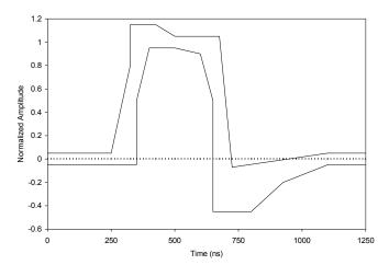
Figure-5 DSX-1 Waveform Template
