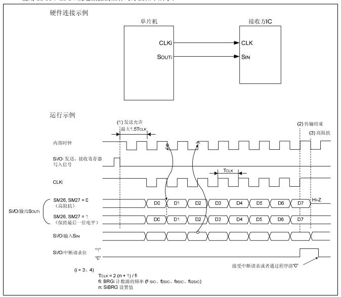
图 1. SI/O3、SI/O4 发送数据的工作时序
