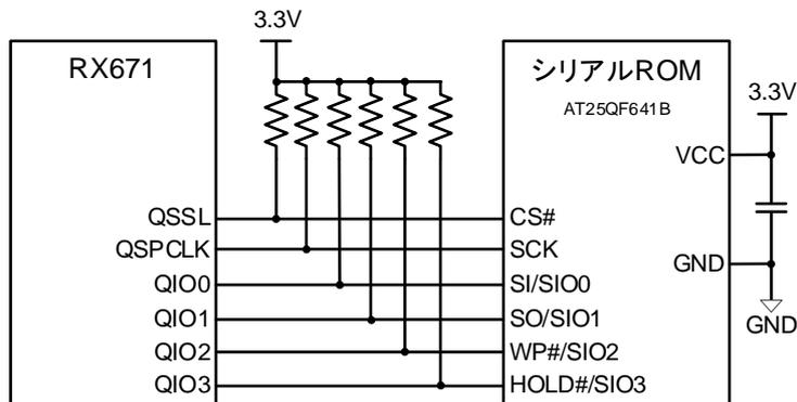
図 4 EK-RX671 ボード搭載の RX671 とシリアル ROM との接続図
