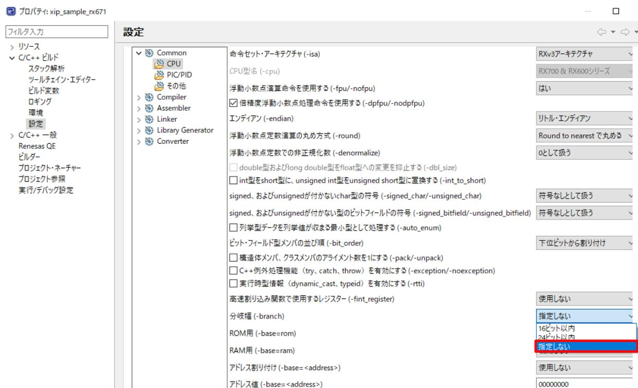
図 12 分岐幅(-branch)オプション設定
