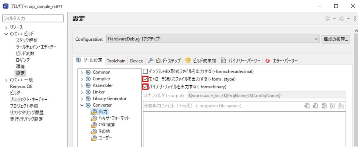
図 10 e<sup>2</sup> studio でのビルド生成ファイルの分割出力設定(1/2)
