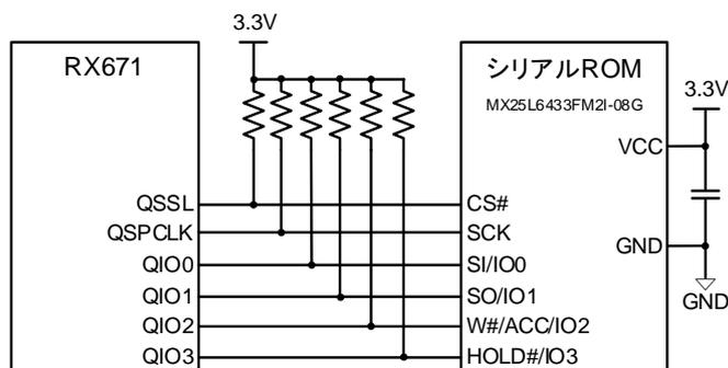
図 2 Renesas Starter Kit+ for RX671 ボード搭載の RX671 とシリアル ROM との接続図
