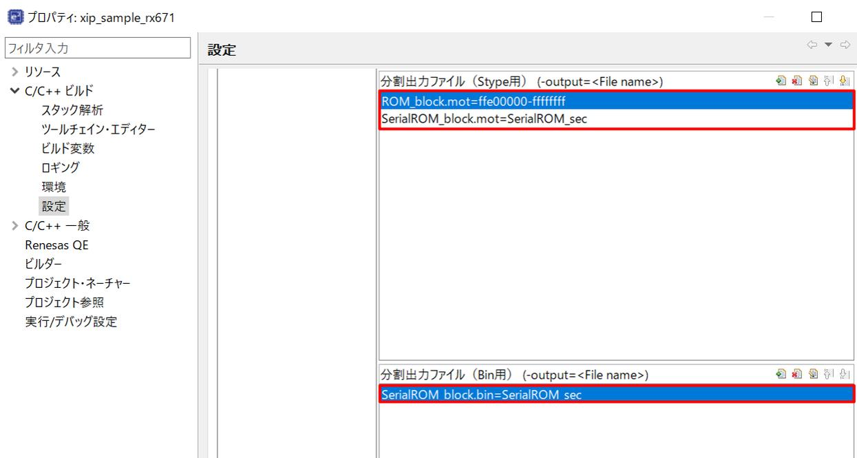
図 11 e<sup>2</sup> studio でのビルド生成ファイルの分割出力設定(2/2)
