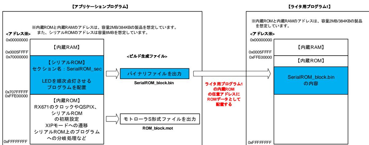
図 16 ライタ用プログラム 1 のバイナリファイル入力とアドレス配置
