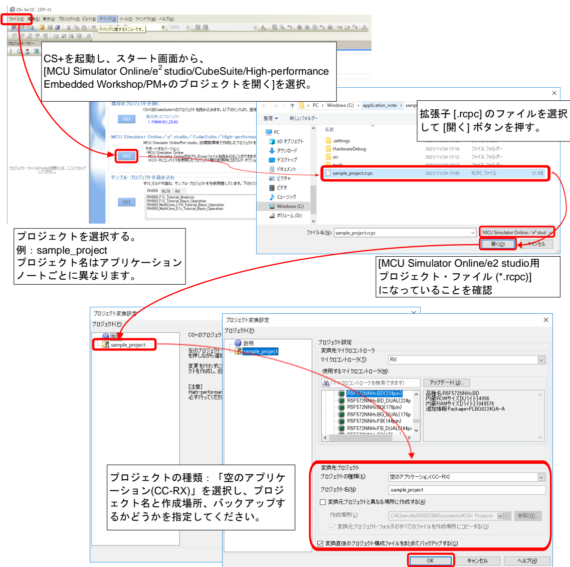
図5.2 プロジェクトをCS+にインポートする方法
