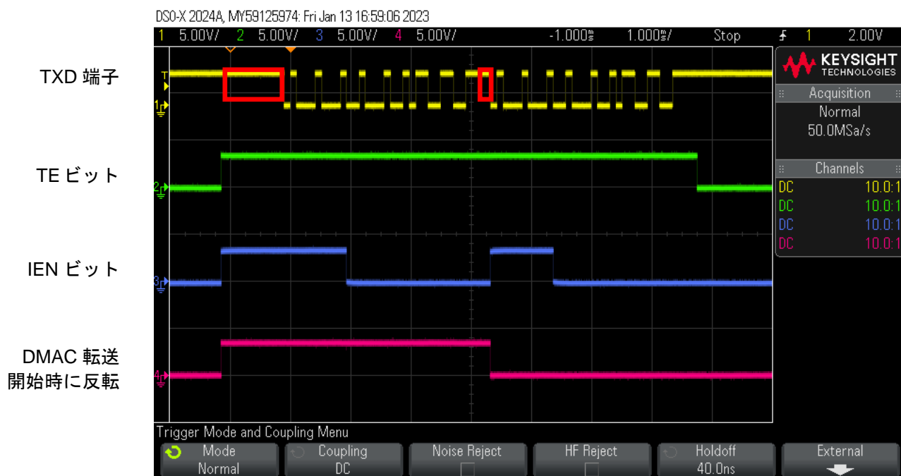
図 3.11 サンプルプログラムの波形
