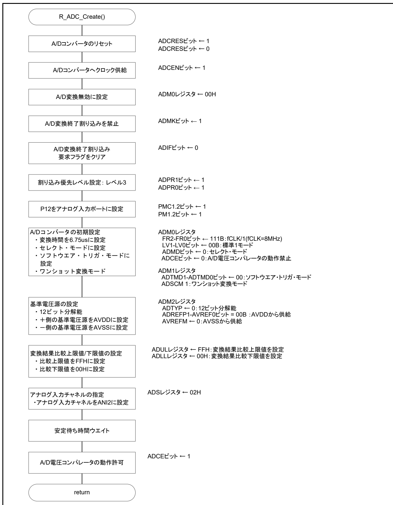
図 5.12 A/D コンバータ初期設定
